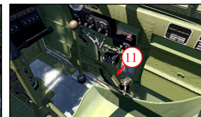
Рычаги шасси и закрылков-левый борт кабины Рычаг радиатора – правый борт кабины
