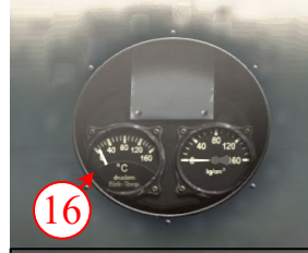
Приборы расположены снаружи на мотогондолах
